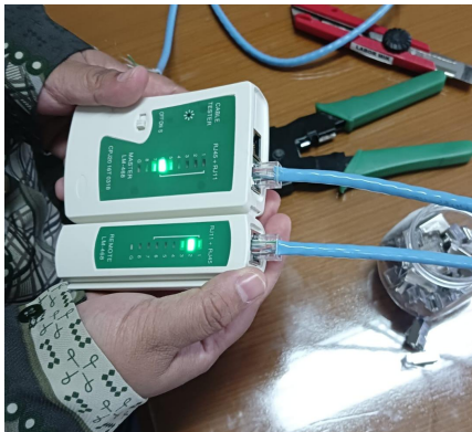
Gambar 3. Proses Tester Kabel LAN
